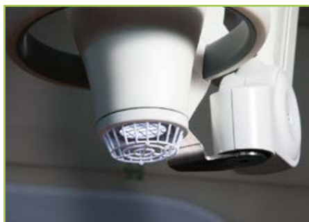
Plasma-Behandlungskopf des SteriPlas-Gerätes. (Foto: Adtec)
